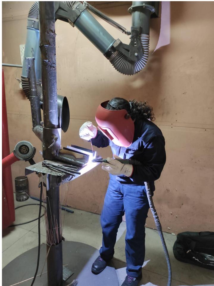
*Figura 2-7 Saldatore con guanti e casco protettivo*
