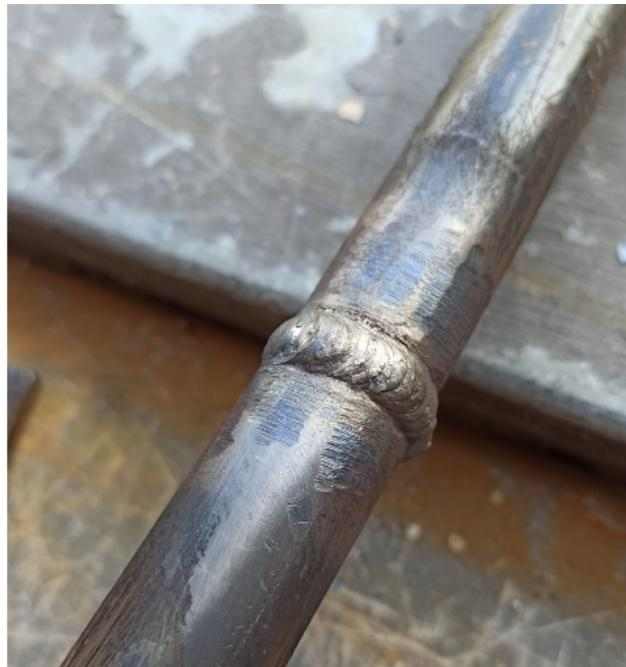
*Figura 3-3 Saldatura testa a testa di tubi*
