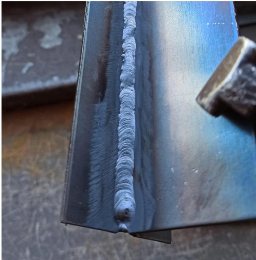
*Figura 3-1 Saldatura di un giunto a T in verticale*
