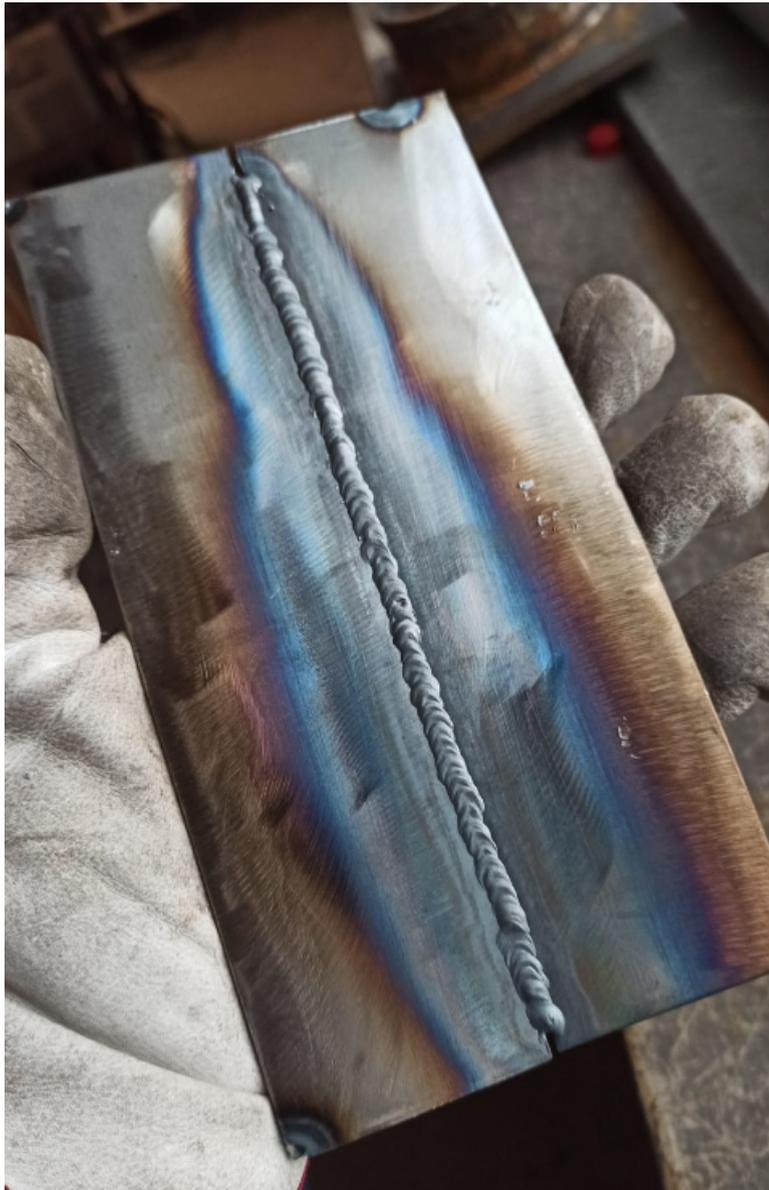
*Figura 3-2 Saldatura testa a testa con gap*
